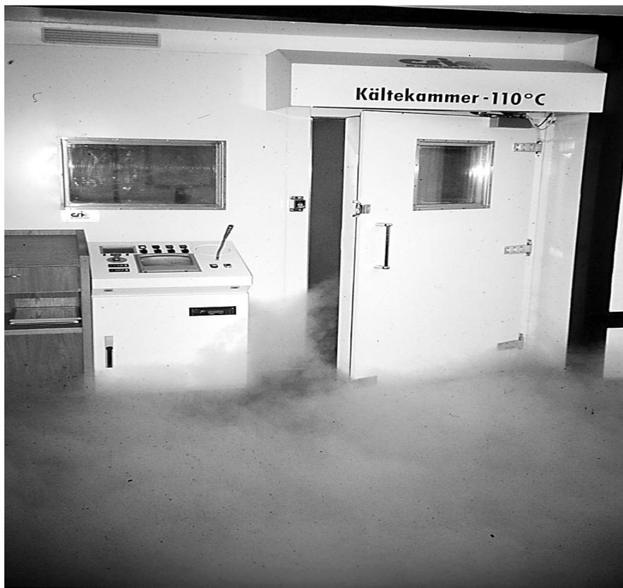
Abbildung 6: Fotografische Darstellung der Kältekammer mit Vor- und Hauptkammer
